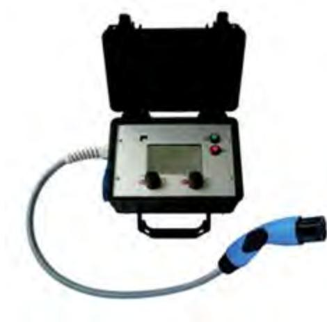
Die Funktionalität des installierten Ladesystems kann wahlweise mit einem Fahrzeug oder mit einem Funktionssimulator geprüft werden.
